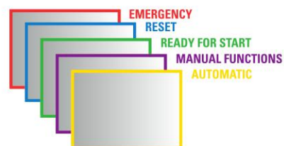
Χρωματιστές ενδείξεις κατάστασης Цветна рамка индикира какъв е статуса на машината
